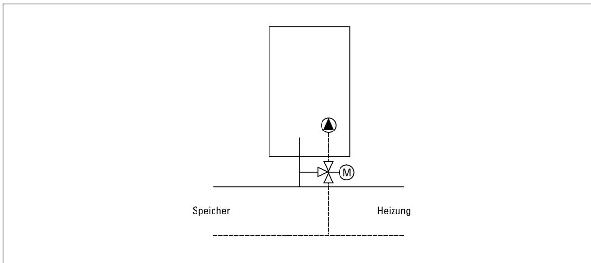
Auch für Heizgeräte mit einer integrierten Pumpe, die im **Kesselrücklauf** ein Umschaltventil für Heizungs- und Brauchwasserbetrieb (z. B. Wandtherme) haben, wird die Anbindung nach
