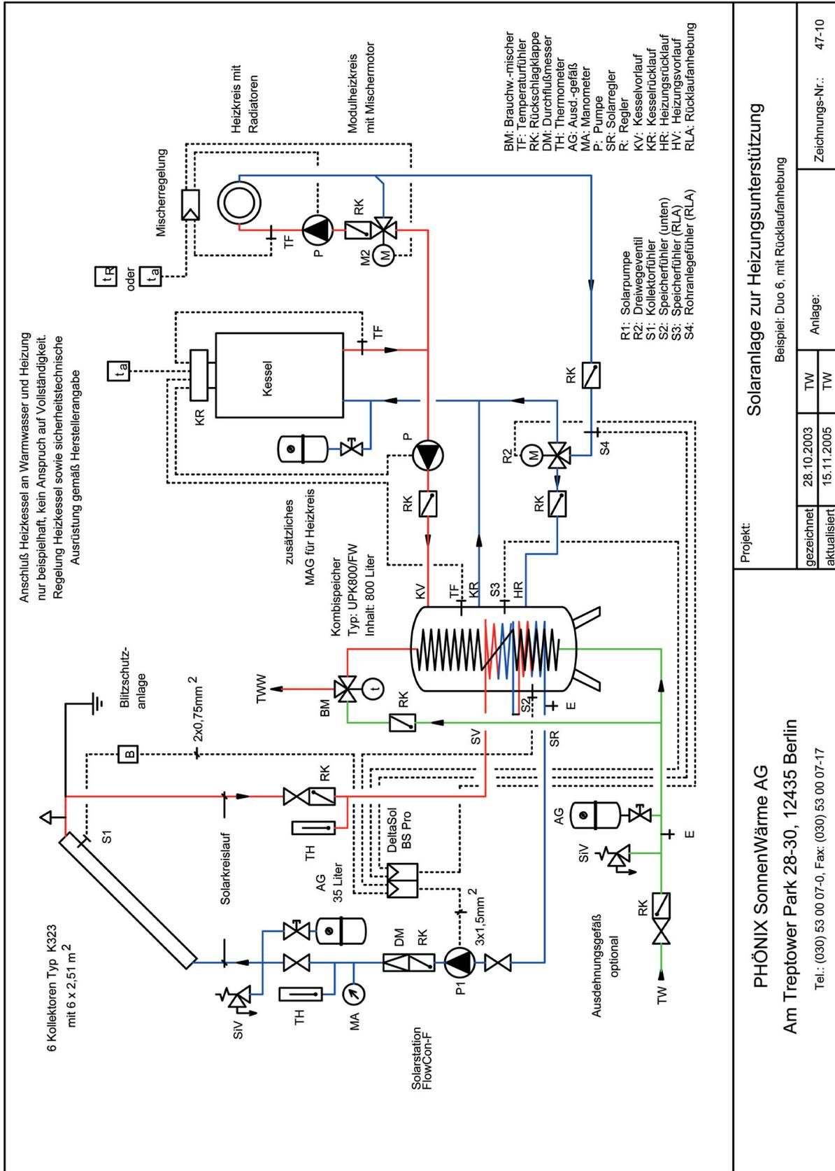
**Solaranlage zur Heizungsunterstützung**
