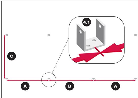
1. Abmaße des gesamten Kollektorfeldes ermitteln und Positionen der U-Stücke (3.1/ 4.1) markieren. Für die Abstände der U-Stücke des ersten und des letzten Kollektors einer Kollektorreihe gilt immer das Maß A, für Kollektoren in der Mitte das Maß B.
