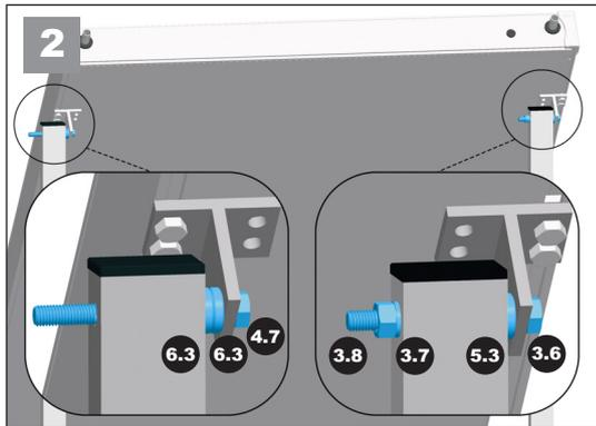
2. Kollektor zu den Trägerrohren (2) neigen. Äußeres T-Stück (5.1) am äußeren Trägerrohr (2) mittels Sechskantschraube M10 x 85 mm (3.6), kleiner Distanzhülse (5.3), Federring (3.7) und Sechskantmutter M10 (3.8) befestigen. Zweites T-Stück (6.1) mittels Sechskantschraube M10 x 100 mm (4.7) und zwei kleiner Distanzhülsen (6.3) vormontieren. Beide äußeren T-Stücke durch Festziehen der Sechskantschrauben M10 x 85 mm (3.6) fixieren.
