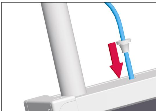
3. Temperaturfühler bis zum Anschlag in die Tauchhülse einführen. Kollektorgehäuse mittels Stopfen abdichten. Dabei auf korrekten Sitz der Stopfen achten.
