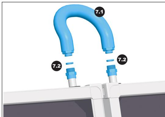
1. Die Kollektoren (1) miteinander in Reihe verbinden. Dazu Verbindungsleitung (7.1) mit Dichtung (7.2) an entsprechende Kollektoranschlüsse montieren. Dabei auf korrekten Sitz der Dichtung achten.
