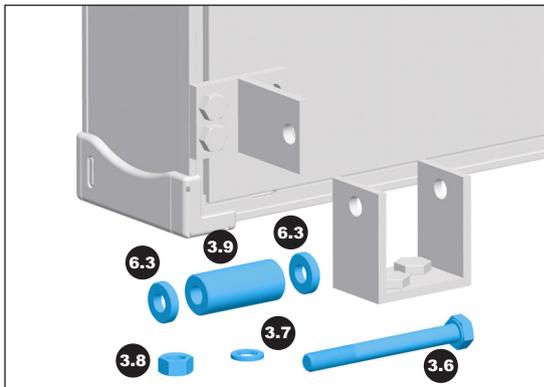
Sechskantschrauben M10 (3.6/ 4.7), kleine Distanzhülsen (6.3), große Distanzhülsen (3.9/ 4.10), Federringe (3.7/ 4.8) und Sechskantmuttern M10 (3.8/ 4.9) zur Kollektorbefestigung bereitlegen.
