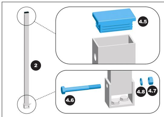
4. Trägerrohr (2) mit Sechskantschraube (3.6/ 4.6), Federring (3.7/ 4.8) und Sechskantmutter (3.8/ 4.9) an den hinteren U-Stücken (3.1/ 4.1) befestigen. Abdeckkappe (3.5/ 4.5) auf Trägerrohr aufsetzen. Schraube so fest anziehen, dass die Trägerrohre senkrecht aufgestellt werden können.
