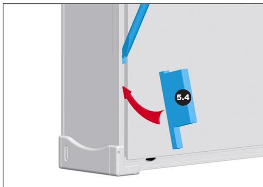
1. Vierkantmutter in der Nut auf der Kollektorrückseite mit einem Schraubenzieher ausrichten und mittels der Montagehilfe (5.4) fixieren.
