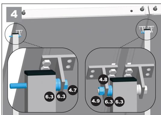
4. Kollektor zu den Trägerrohren (2) neigen. Erst zwei kleine Distanzhülsen (6.3), dann den Kollektor mit T-Stück (6.1) und folgend Federring (4.8) und Sechskantmutter M10 (4.9) auf der vormontierten Sechskantschraube M10 x 100 mm (4.7) befestigen. Zweites T-Stück mittels Sechskantschraube M10 x 100 mm (4.7) und zwei kleiner Distanzhülsen (6.3) vormontieren. Die Sechskantschrauben M10 x 100 mm (4.7) zwischen den Kollektoren festziehen.
