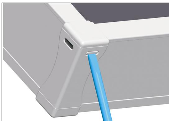
5. Entsprechend der Aufstellung an beiden unteren Kollektorecken jeweils beide Entwässerungslöcher mit Hilfe eines Schlitzschraubenziehers ausbrechen. Dabei an der Unterkante ansetzen.
