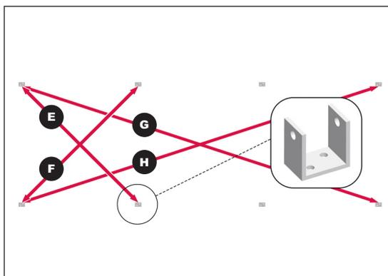
2. Vor dem Bohren der Löcher im Untergrund für die U-Stücke (3.1/ 4.1) Abstände anhand der Diagonalen kontrollieren. Die Diagonalen E und F sowie G und H müssen jeweils gleich lang sein. Anschließend mit Steinbohrer  $\varnothing 10$  mm an den markierten Stellen bohren.
