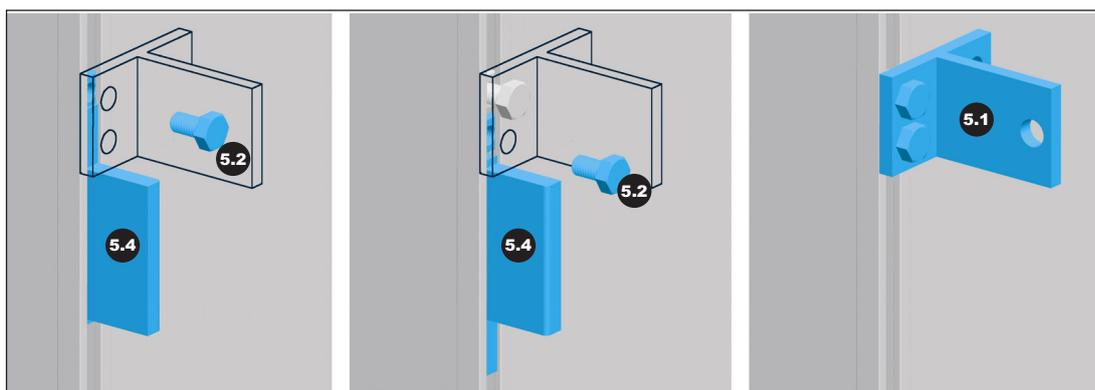
2. Vier T-Stücke (5.1/ 6.1) je Kollektor mit Sechskantschrauben M8 (5.2/ 6.2) an den Vierkantmuttern in der Nut auf der Kollektorrückseite vormontieren. Dazu die erste Vierkantmutter mit Hilfe der langen Seite der Montagehilfe ausrichten. Das T-Stück ansetzen und eine Sechskantschraube einschrauben. Durch drehen der Montagehilfe die zweite Vierkantmutter ausrichten und eine weitere Sechskantschraube einschrauben.
