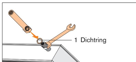
Bei der Montage des Entlüfters auf dem Dach muss zunächst das T-Stück mit vormontiertem Entlüfter auf den Kollektorfeldanschlüssen befestigt werden (sowohl im Voral als auch im Rücklauf). Zwischen Kollektor und T-Stück muß eine Dichtung eingelegt werden.
