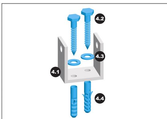
3. Dübel (3.4/ 4.4) einsetzen und U-Stücke (3.1/ 4.1) mit Unterlegscheiben (3.3/ 4.3) und Holzschrauben (3.2/ 4.2) befestigen. Falls U-Schienen verwendet werden, diese ebenfalls mit Unterlegscheiben (3.3/ 4.3) und Holzschrauben (3.2/ 4.2) befestigen.
