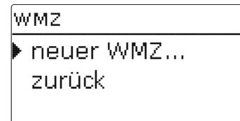
Im Menü WMZ können bis zu sieben interne Wärmemengenzähler aktiviert und eingestellt werden. Mit dem Menüpunkt **neuer WMZ...** kann ein weiterer Wärmemengenzähler hinzugefügt werden.
