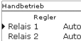
Im Menü **Handbetrieb** kann der Betriebsmodus aller Relais im Regler und in angeschlossenen Modulen eingestellt werden.
