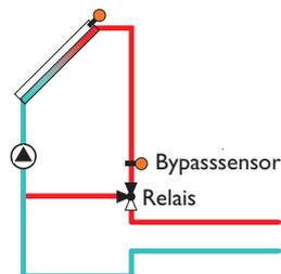
Beispielschemata für die verschiedenen Bypass-Varianten
