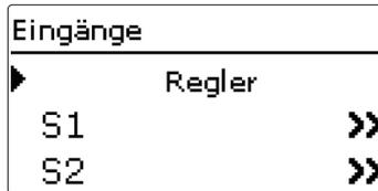
In diesem Untermenü kann für jeden Sensoreingang eingestellt werden, welcher Sensortyp angeschlossen ist. Zur Auswahl stehen:
