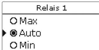
Für jedes Relais kann auch einzeln ein Betriebsmodus gewählt werden. Folgende Einstellmöglichkeiten stehen zur Verfügung:
