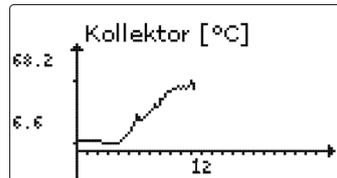
Das Verlaufsdiagramm zeigt die Temperaturentwicklung am entsprechenden Sensor über die letzten 24 Stunden an. Mit den Tasten  $\leftarrow$  und  $\rightarrow$  kann zwischen Darstellungen des laufenden Tages und des Vortages gewechselt werden.
