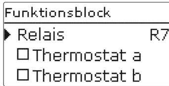
Zusätzlich zu den vordefinierten Wahlfunktionen stehen Funktionsblöcke zur Verfügung, die sich aus Thermostat-, Timer und Differenzfunktionen zusammensetzen. Mit ihnen lassen sich weitere Komponenten bzw. Funktionen realisieren.
