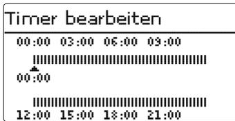
Die Zeitfenster können in Schritten von je 15 Minuten eingestellt werden. Mit den Tasten **2** und **4** kann der Cursor auf der Zeitschiene bewegt werden.
