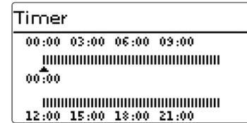
Die Zeitfenster für die Timer werden auf einer Zeitschiene in Schritten von je 15 Minuten eingestellt. Mit den Tasten **2** und **4** kann der Cursor auf der Zeitschiene bewegt werden. Mit Taste **1** wird ein Zeitpunkt als Beginn eines Zeitfensters gewählt. Um das Zeitfenster abzuschließen, bei Erreichen des gewünschten Endzeitpunktes Taste **3** drücken.
