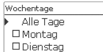
Die Zeitfenster können in Schritten von je 15 Minuten eingestellt werden. Mit den Tasten **2** und **4** kann der Cursor auf der Zeitschiene bewegt werden. Mit Taste **A** wird ein Zeitpunkt als Beginn eines Zeitfensters gewählt. Um das Zeitfenster abzuschließen, bei Erreichen des gewünschten Endzeitpunktes Taste **5** drücken.
