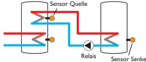
Die Wärmeaustauschfunktion dient dazu, Wärme von einer Wärmequelle an eine Wärmesenke zu übertragen.
