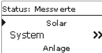
Im Menü Status/Mess-/Bilanzwerte werden alle aktuellen Messwerte sowie verschiedene Bilanzwerte angezeigt. Einige der Anzeigezeilen können angewählt werden, um in ein Untermenü zu gelangen.
