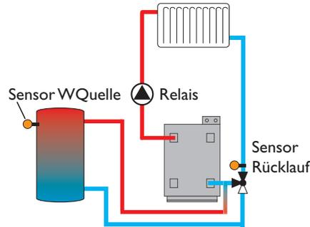
Die Funktion Rücklaufanhebung dient dazu, Wärme aus einer Wärmequelle an den Heizkreisrücklauf zu übertragen.
