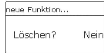
Wird der Punkt **Funktion löschen** mit Taste **5** bestätigt, erscheint eine Sicherheitsabfrage. Mit den Tasten **2** und **4** kann zwischen Ja und Nein gewechselt werden. Wird ja eingestellt und mit Taste **5** bestätigt, ist die Funktion gelöscht und steht wieder unter **neue Funktion...** zur Verfügung. Die entsprechenden Relais sind wieder freigegeben.
