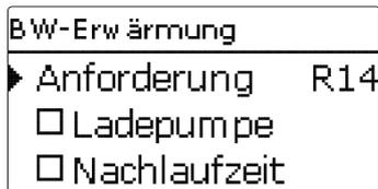
Die Brauchwassererwärmung dient dazu, durch Anforderung einer Nachheizung den Brauchwasserspeicher zu erwärmen.
