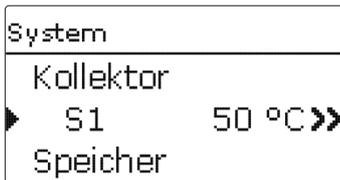
Wenn z. B. Solar/System angewählt wird, öffnet sich ein Untermenü mit den vom solaren System belegten Sensoren und Relais, in dem die aktuellen Temperaturen, bzw. die aktuelle Drehzahl angezeigt werden.
