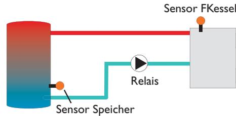
Die Funktion Festbrennstoffkessel dient dazu, Wärme aus einem Festbrennstoffkessel an einen Speicher zu übertragen.
