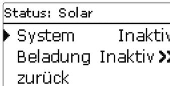
Im Menü Status/Solar wird der Status des solaren Systems, der solaren Beladung und der ausgewählten Wahlfunktionen angezeigt.
