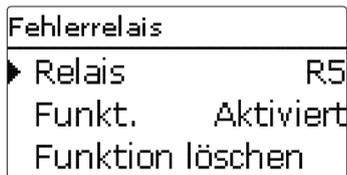
Die Funktion Fehlerrelais dient dazu, ein Relais im Fehlerfall zu schalten. So kann z. B. ein Signalgeber angeschlossen werden, der Fehlerfälle meldet.
