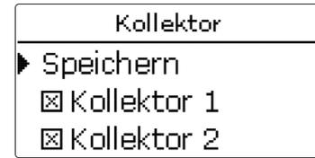
Wenn aus verschiedenen Auswahlmöglichkeiten mehrere gleichzeitig gewählt werden können, werden sie mit Checkboxes angezeigt. Wenn ein Punkt angewählt wird, erscheint ein x innerhalb der Checkbox.
