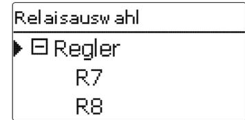
Wenn vor einem Menüpunkt das Symbol zu sehen ist, kann mit Taste 5 ein Untermenü ‚aufgeklappt‘ werden. Ist es bereits aufgeklappt, ist statt des ein zu sehen.
