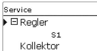
Im Menü Status/Service wird für jeden Sensor und jedes Relais angezeigt, welcher Komponente oder welcher Funktion es zugewiesen ist. Bei freien Sensoren und Relais wird **Frei** angezeigt.
