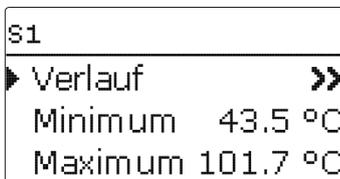
Wenn z. B. S1 angewählt wird, öffnet sich ein Untermenü, in dem der Minimal- und Maximalwert angezeigt werden.
