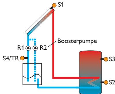
Beispielschema für eine Drainback-Anlage
