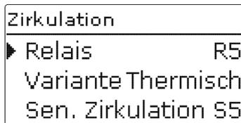
Die Zirkulationsfunktion dient zur Regelung und Ansteuerung einer Zirkulationspumpe.
