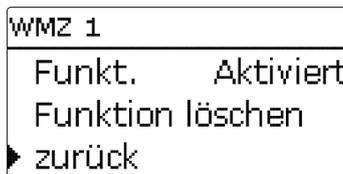
Wenn ein bereits ausgewählter Wärmemengenzähler angewählt wird, öffnet sich wieder das oben beschriebene Menü mit allen Einstellwerten.
