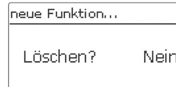
Wird der Punkt **Funktion löschen** mit Taste ⑤ bestätigt, erscheint eine Sicherheitsabfrage. Mit den Tasten ② und ④ kann zwischen Ja und Nein gewechselt werden. Wird ja eingestellt und mit Taste ⑤ bestätigt, ist die Funktion gelöscht und steht wieder unter **neue Funktion...** zur Verfügung. Die entsprechenden Relais sind wieder freigegeben.
