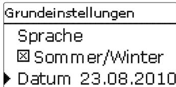
Im Menü Grundeinstellungen können alle Basis-Parameter für den Regler eingestellt werden. Normalerweise sind diese Einstellungen bereits im Inbetriebnahmemenü gemacht worden. Sie können hier nachträglich verändert werden.
