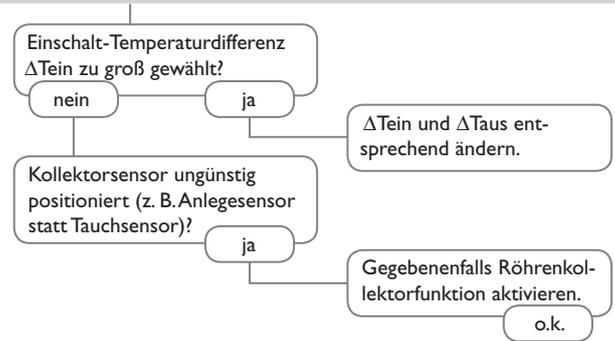
Pumpe läuft kurz an, schaltet ab, schaltet wieder an usw. („Reglerflattern“)
