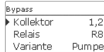
Die Bypassfunktion dient dazu, einen Energieaustausch aus dem Speicher direkt nach dem Einschalten der Beladung zu verhindern. Das in den Rohrleitungen befindliche, noch kalte Wärmeträgermedium wird über einen Bypass am Speicher vorbeigeleitet. Die Beladung wird erst begonnen, wenn die Zuleitung ausreichend erwärmt ist. Die Einschaltbedingungen können individuell eingestellt werden.
