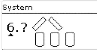
Der Regler ist für 9 solare Grundsysteme vorprogrammiert. Die Auswahl erfolgt entsprechend der Anzahl der Wärmequellen (Kollektorfelder) und Wärmesenken (Speicher, Schwimmbad). Die Werkseinstellung ist System 1.
