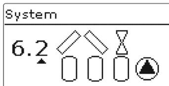
Nachdem die Auswahl des Systems bestätigt wurde, kann die hydraulische Variante gewählt werden. Die jeweilige Variante wird im Display mit Pumpen- und Ventilsymbolen visualisiert. Das Beispielbild zeigt die Variante 2 von System 6 mit einem 2-Wege-Ventil und einer Pumpe. Für eine Übersicht über die Systeme und ihre Varianten siehe Kap. 5.2 auf Seite 15.
