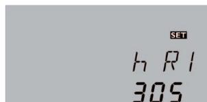
Der Betriebsstundenzähler summiert die Betriebsstunden des jeweiligen Relais (**h R1 / h R2 / h R3 / h R4**). Im Display werden volle Stunden angezeigt.
