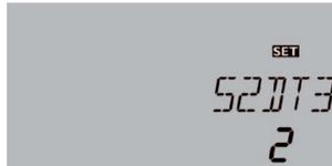
Bei der Wärmeaustauschfunktion ist der Bezugssensor (Wärmequelle) für den Speicher 1 der Sensor S3 (TSPO). Der Bezugssensor (Wärmesenke) für den Speicher 2 (S2DT3) ist S4. Dieser kann auf S5 gewechselt werden und ist für die Differenzfunktion als Referenzsensor und für die Maximalbegrenzung zuständig.
