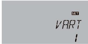
Die Wärmemengenzählung bzw. -bilanzierung kann auf 3 verschiedene Arten erfolgen (siehe unten): ohne Volumenmessteil, mit Volumenmessteil V40 oder mit Grundfos-Sensoren.
