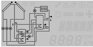
Im System-Monitoring-Display wird das ausgewählte Schema angezeigt. Es besteht aus mehreren Systemkomponenten-Symbolen, die je nach Anlagenzustand blinken, dauerhaft angezeigt oder verborgen werden.
