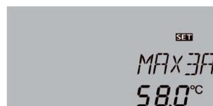
Wenn der eingestellte Wert **MAX3E** überschritten wird, wird das Relais deaktiviert. Wenn der eingestellte Wert **MAX3A** unterschritten wird, schaltet das Relais wieder ein.
