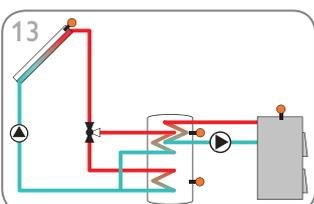
13 Solarsystem mit Schichtenspeicher und Nachheizung über Festbrennstoffkessel (Seite 33)
