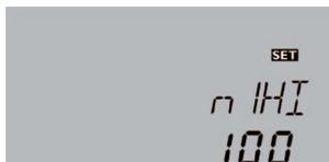
In dem Einstellkanal **n1(2, 3)HI** kann für die Ausgänge R1, R2 und R3 eine relative Maximaldrehzahl für angeschlossene Pumpe vorgegeben werden.
