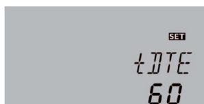
Mit dem Parameter **tDTE** wird die Zeitspanne, in der die Einschaltbedingung dauerhaft gegeben sein muss, eingestellt.
