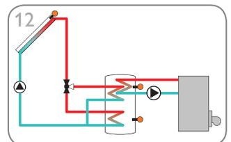
12 Solarsystem mit Schichtenspeicher und thermostatischer Nachheizung (Seite 31)
