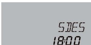
Wenn die Option „Thermische Desinfektion“ (**OTDES**) aktiviert ist und ein Startzeitpunkt zur Verzögerung eingegeben wurde, wird dieser eingestellte Zeitpunkt blinkend angezeigt.
