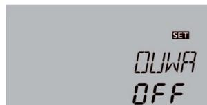
Wenn die Überwärmeabfuhr **OUWA** aktiviert wird, wird das ausgewählte Relais mit 100% geschaltet, wenn die Kollektortemperatur die eingestellte Kollektor-Übertemperatur **UTKL** erreicht. Wenn die Kollektortemperatur um 5 K unter die eingestellte Kollektor-Übertemperatur **UTKL** sinkt, wird das Relais wieder abgeschaltet.
