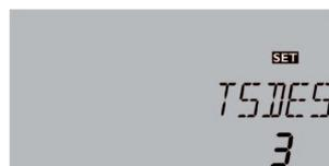
Für die Funktion können freie Sensoren mit sinnvoller Positionierung ausgewählt werden. Voreingestellter Sensor für die thermische Desinfektion ist S3.
