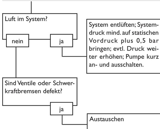
Pumpe läuft kurz an, schaltet ab, schaltet wieder an usw. („Reglerflattern“)
