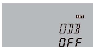
Durch die Drainback-Option **ODB** fließt das Wärmeträgermedium zurück in den Vorratsbehälter, wenn eine Solarernte nicht möglich ist. Wenn die Drainback-Funktion aktiviert ist, können die im Folgenden beschriebenen Einstellungen vorgenommen werden (**tDTO**, **tFLL** und **tSTB**):
