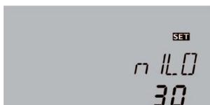
In dem Einstellkanal **n1(2, 3)LO** kann für die Ausgänge R1, R2 und R3 eine relative Minimaldrehzahl für angeschlossene Pumpe vorgegeben werden.
