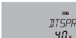
**Option Spreizladung OSPRE:** In 2-Speicher-Systemen mit zwei Pumpen kann eine Spreizfunktion aktiviert werden:Sobald die einstellbare Spreizdifferenz **DTSPR** zwischen Kollektor und Vorrangspeicher überschritten ist, wird der zweite Speicher parallel beladen, sofern er sich nicht solar gesperrt ist. Wenn **DTSPR** um 2 K unterschritten wird, schaltet die Pumpe wieder ab.
