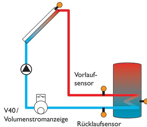
Beispiel für die Positionierung der Vor- und Rücklaufsensoren
