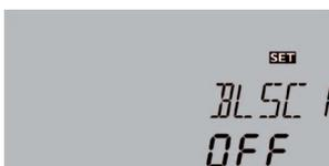
Um das Blockieren von Pumpen bei längerem Stillstand zu verhindern, verfügt der Regler über eine zuschaltbare Blockierschutzfunktion. Diese Funktion schaltet die Relais täglich um 12:00 nacheinander für 10 s mit 100 % Drehzahl ein.
