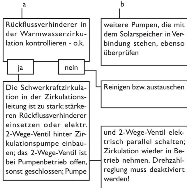
Die Solarkreispumpe läuft nicht, obwohl der Kollektor deutlich wärmer als der Speicher ist
