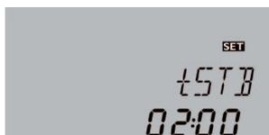
Mit dem Parameter **tSTB** wird die Zeitspanne eingestellt, in der die Ausschaltbedingung nach Beenden der Befüllzeit ignoriert wird.
