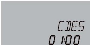
Wenn die Option „Thermische Desinfektion“ (**OTDES**) aktiviert ist und die Überwachungsperiode läuft, wird die restliche Überwachungsperiode als **CDES** rückwärtslaufend angezeigt (in Tagen und Stunden).
