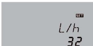
Zeigt den gemessenen momentanen Volumenstrom in der Solaranlage an. Dieser dient der Ermittlung der übertragenen Wärmemenge (V40 /VFS).
