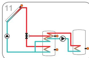
11 Solarsystem mit Schichtenspeicher und Wärmeaustauschregelung (Seite 29)
