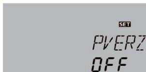
Diese Funktion dient dazu, die Stellzeit von verwendeten Ventilen zu berücksichtigen und schaltet die Pumpe verzögert ein.
