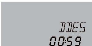
Wenn die Option „Thermische Desinfektion“ (**OTDES**) aktiviert ist und die Erhitzungsperiode läuft, wird die restliche Zeit der Erhitzungsperiode rückwärtslaufend angezeigt (in Stunden und Minuten.)
