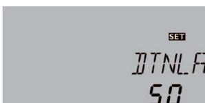
Mit dieser Funktion wird die Beladung des Speichers auch nach Unterschreiten der Ausschaltendifferenz zwischen Kollektor und Speicher fortgesetzt. Sie schaltet ab, wenn die eingestellte DT-Nachlaufendifferenz zwischen Vor- und Rücklaufsensor unterschritten wird.
