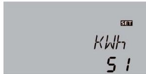
Zeigt die im System gewonnene Wärmemenge an. Dazu muss die Option Wärmengenzählung aktiviert sein.
