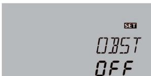
Diese Funktion dient dazu, eine 2. Pumpe während des Befüllens der Anlage zusätzlich einzuschalten. Wird die solare Beladung gestartet, so wird R3/R4 parallel zu R1 geschaltet. Nach Ablauf der Befüllzeit (**tFLL**) wird R3/R4 ausgeschaltet.
