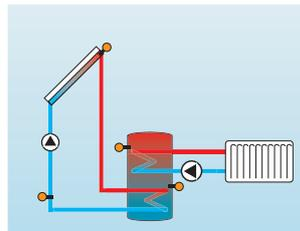
Die Thermostatfunktion arbeitet unabhängig vom Solarbetrieb und kann z. B. für eine Überschusswärmenutzung oder eine Nachheizung eingesetzt werden.
