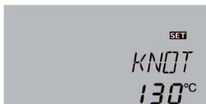
Wenn die Kollektortemperatur die eingestellte Kollektorgrenztemperatur (**KNOT / KNOT1 / KNOT2**) überschreitet, schaltet die Solarpumpe (R1 / R2) aus, um einer schädigenden Überhitzung der Solarkomponenten vorzubeugen (Kollektornotabschaltung). Bei überschrittener Kollektorgrenztemperatur blinkt im Display  $\Delta$ .
