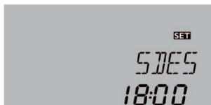
Wird in **SDES** eine Startzeit für die Thermische Desinfektion mit Startzeitverzögerung eingestellt, wird die Thermische Desinfektion bis zu dieser Uhrzeit hinausgezögert, nachdem **CDES** bis auf 00:00 heruntergezählt hat. Endet CDES zum Beispiel um 12:00 Uhr und SDES wurde auf 18:00 eingestellt, wird Relais 2 um 18:00 anstatt um 12:00 Uhr, also mit 6 Stunden Verzögerung geschaltet.
