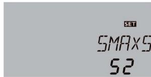
Zuweisung des Sensors für die Speichermaximalbegrenzung. Die Maximalabschaltung bezieht sich dann immer nur auf den ausgewählten Sensor. Bei Auswahl von S3 wird die Differenzregelung weiterhin über S1 und S2 durchgeführt. Die Temperatur an S2 kann jedoch die vorgegebene Grenztemperatur überschreiten, ohne dass die Anlage abschaltet. Wenn jedoch S3 die Begrenzung erreicht, wird abgeschaltet.
