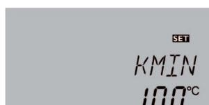
Die Kollektorminimalbegrenzung dient dazu, eine Mindest-Einschalttemperatur vorzugeben, die überschritten werden muss, damit die Solarpumpe (R1 / R2) einschaltet. Die Mindesttemperatur verhindert ein zu häufiges Einschalten der Solarpumpe bei geringen Kollektortemperaturen. Wenn die Kollektortemperatur die eingestellte Minimaltemperatur unterschreitet, blinkt  $\star$  im Display.
