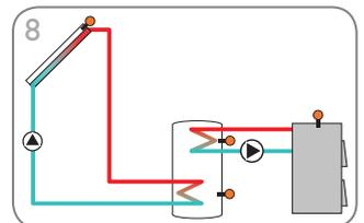
8 Solarsystem mit 1 Speicher und Nachheizung über Festbrennstoffkessel (Seite 23)
