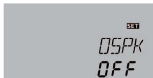
Wenn die Speicherkühlfunktion aktiviert wird, kühlt der Regler den Speicher über Nacht ab, um diesen für die solare Beladung am folgenden Tag vorzubereiten.
