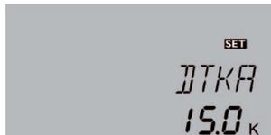
Die Systemkühlung dient dazu, das Solarsystem für eine längere Zeit betriebsbereit zu halten. Sie ignoriert die Speichermaximaltemperatur, um das Kollektorfeld und das Wärmeträgermedium an Tagen starker Einstrahlung thermisch zu entlasten.
