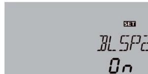
In einem 2-Speicher-System kann der zweite Speicher über den Parameter **BLSP2** abgeschaltet werden.
