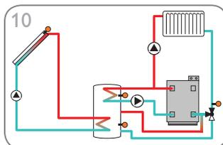
10 Solarsystem mit 1 Speicher, Heizkreis-Rücklaufanhebung und thermostatischer Nachheizung (Seite 27)
