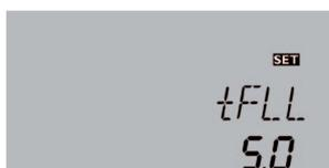
Mit dem Parameter **tFLL** wird die Befüllzeit eingestellt. Während dieser Zeit wird die Pumpe mit 100 % Drehzahl gefahren.
