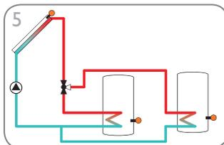
5 2-Speicher-Solarsystem mit Ventillogik, 1 Pumpe, 3 Sensoren und 3-Wege-Ventil (Seite 17)
